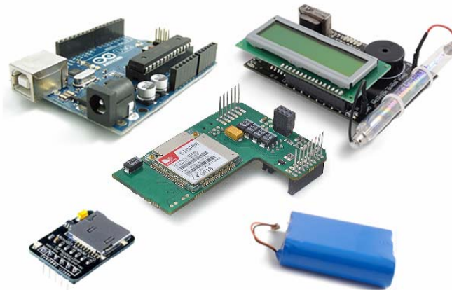
Figura 3 – Componentes: Arduino UNO, Kit Geiger, microSD, GPS e Bateria.
