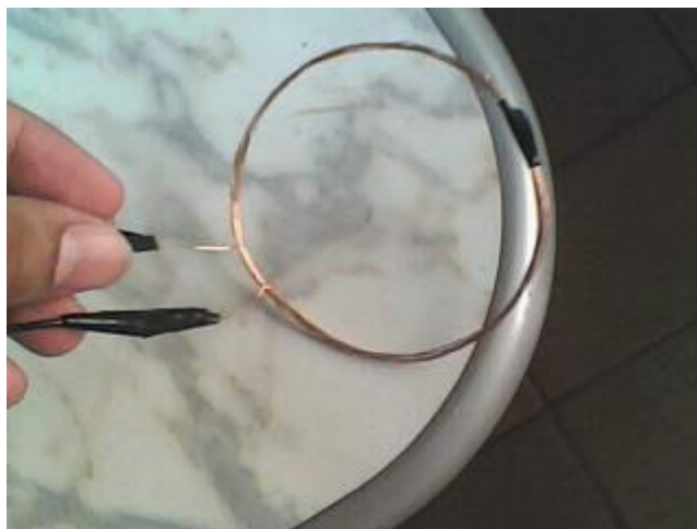
Foto 2: espira pronta, utilizando um fio de aproximadamente 70cm.
