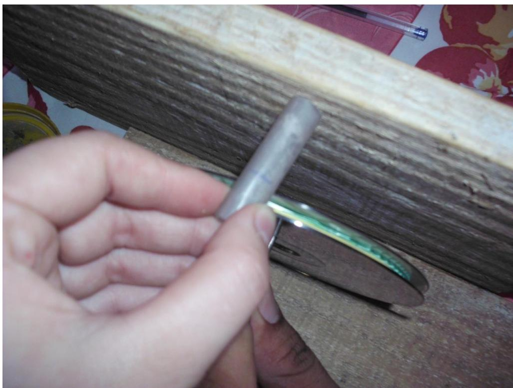
12- Corte a mangueira no tamanho que você marcou para ficarem alinhados. Coloque uma arruela de um lado do disco, passe um parafuso pelo centro do disco e do outro lado coloque a mangueira cortada;
