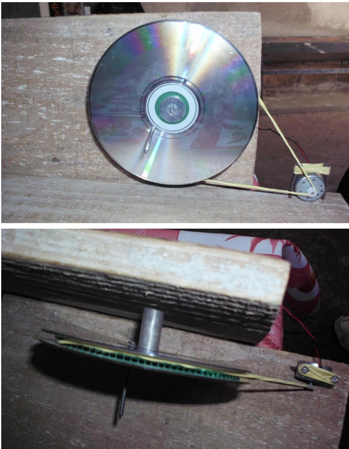
14- Coloque um LED na ponta desencapada dos fios do motorzinho;
