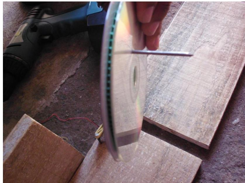
11- Depois, alinhe o centro dos discos de pasta com o centro da roldana que tem no motorzinho, use um pedaço de mangueira para marcar o espaçamento entre o disco e a madeira para que os centros fiquem alinhados;
