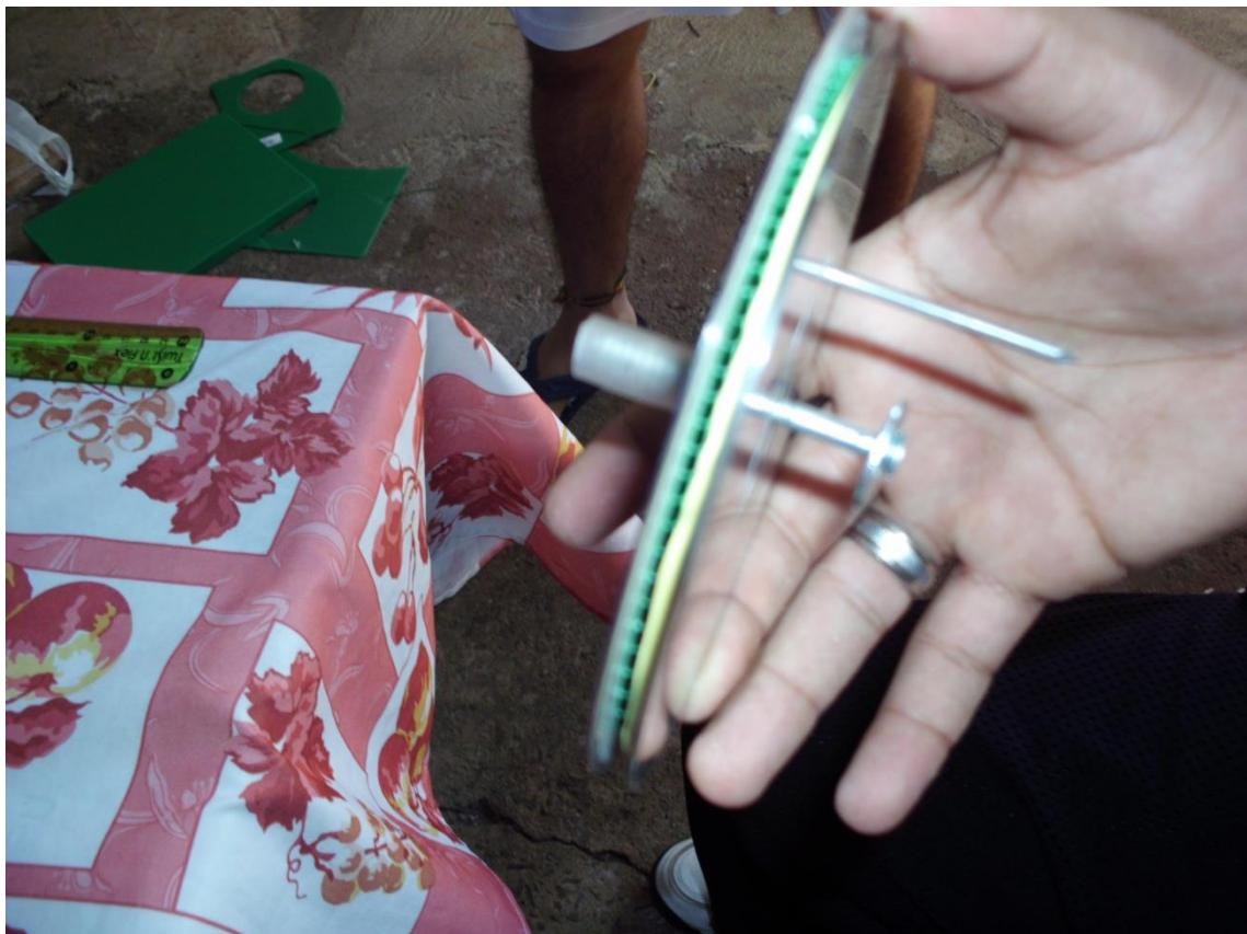
13- Depois é só utilizar o parafuso para parafusar todo esse esquema na madeira que está na vertical, servindo de base para o experimento. Depois de parafusado, passe um elástico unindo o centro do disco com a roldana do motorzinho;
