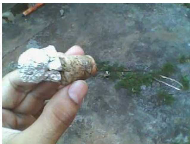
Foto 6: Esquema com fio passado através da rolha e a bolinha de papel alumínio conectada na extremidade.
