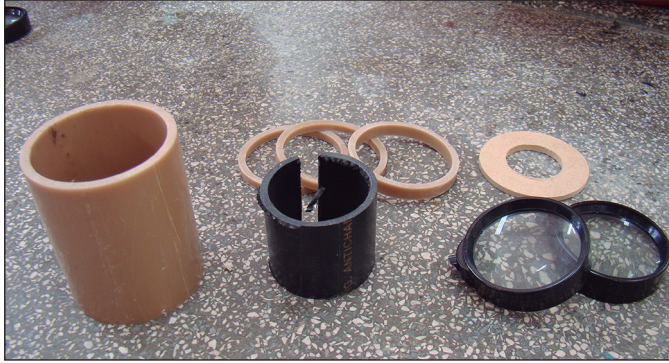
Figura 4.11 Pedacos de tubo em PVC para instalação da lente ocular.
