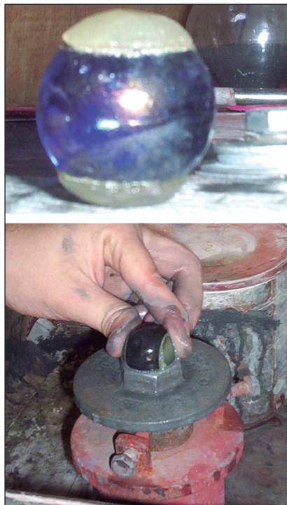
Figura 4.9 Obtenção da ocular utilizando bolinhas de gude.
