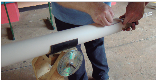
Figura 4.13 Alinhamento e adequação do tubo da luneta.
