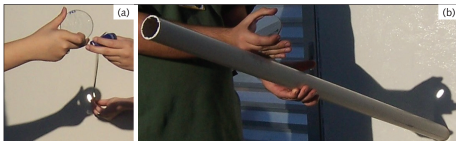
Figura 4.5 Determinação da distância focal da lente objetiva, em (a) e (b).
