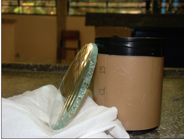
Figura 1.5 Lente convergente plano-convexa.
