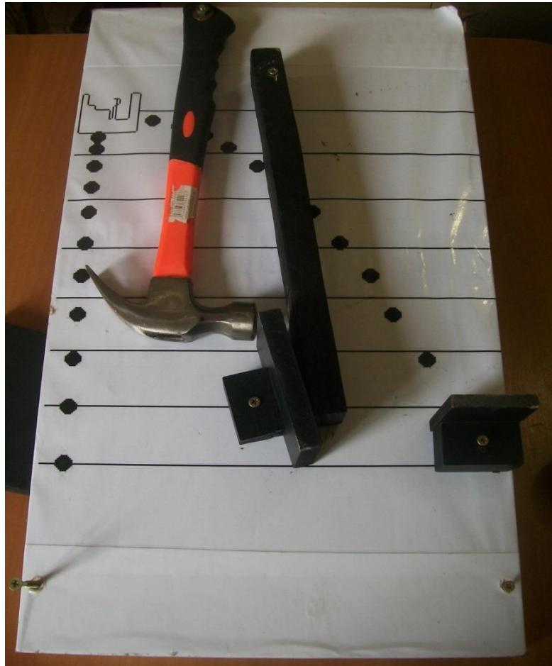
Então instalamos os suportes trazeiros e colocamos as bolinhas de forma que possam ser soltas simultaneamente com a colisao entre o martelo e o braço semi-fixo de madeira:
