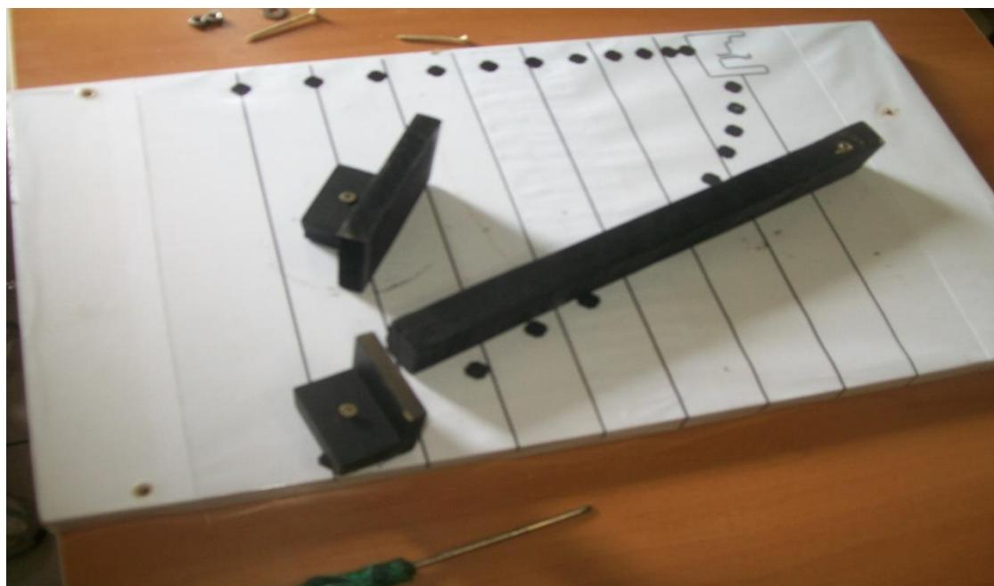
Colocamos então, o parafuso de construção na parte superior da placa de madeira de modo que não bata nos suportes, acertando somente o braço ja fixado, e colamos as lixas no suporte para que as bolinhas nao caiam:
