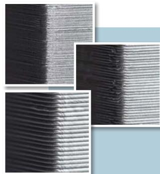
Imagem 4: Detalhes da superfície de algumas impressões 3D mostrando a diferença na superfície de acordo com a altura de camada. Na esquerda, a peça foi impressa com uma altura de camada mais baixa e a peça da direita, com uma altura de camada mais alta.
