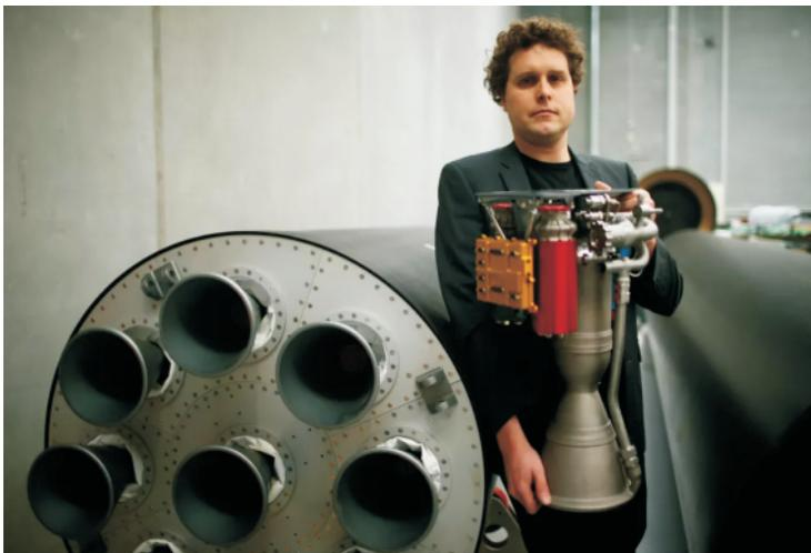
Imagem 6: o engenheiro Peter Beck, CEO da Rocket Lab, segura um motor Rutherford, fabricado com impressão 3D. Fonte: [www.rocketlabusa.com](http://www.rocketlabusa.com)
